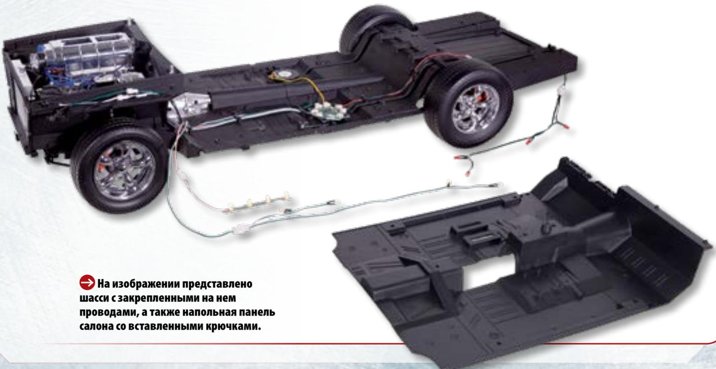
➔ На изображении представлено шасси с закрепленными на нем проводами, а также напольная панель салона со вставленными крючками.
